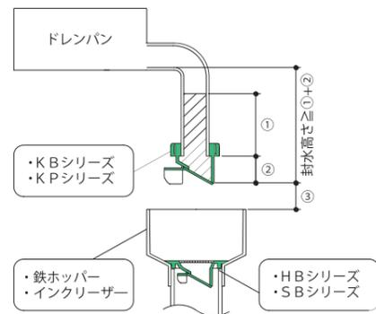
封水高さ [mm] ①空調機的全静圧に対して必要な高さ (全静圧 [Pa] ÷ 9.8)
