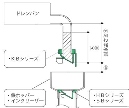
封水高さ [mm] ④ ≥ 下記※参照 (ダンパー開口までの排水容量の高さ)
